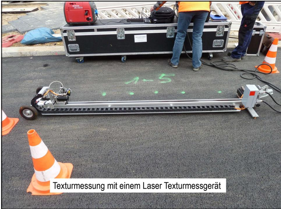
Texturmessung mit einem Laser Texturmessgerät
